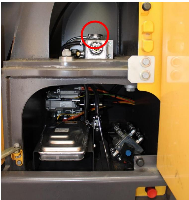
Abbildung 34: Befüll Stutzen Kabinenheizung
